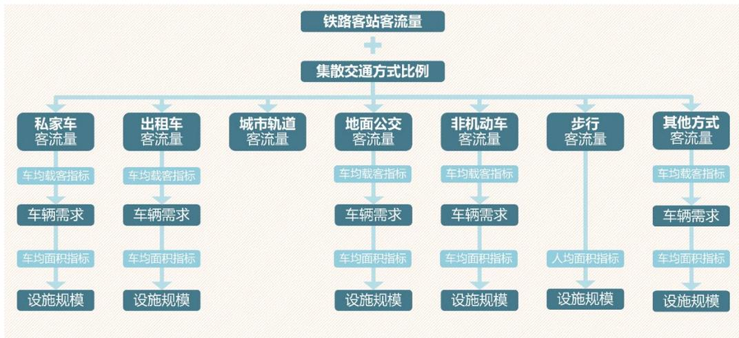
图7.1.3-1 铁路客站集散交通设施规模预测的基本思路
