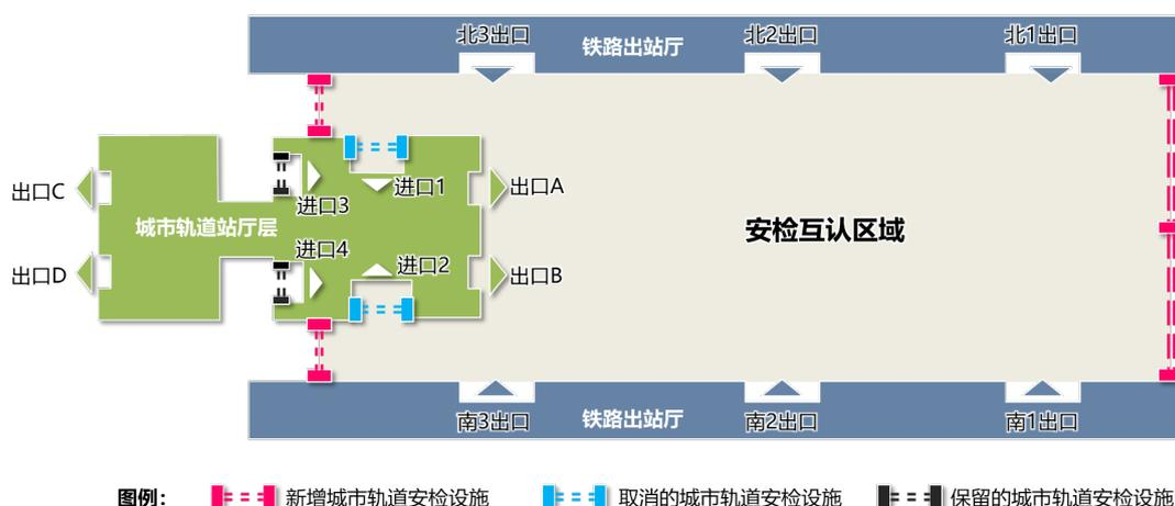
图7.2.4-1 扩大城市轨道交通安检区范围实现安检互认的形式示意
